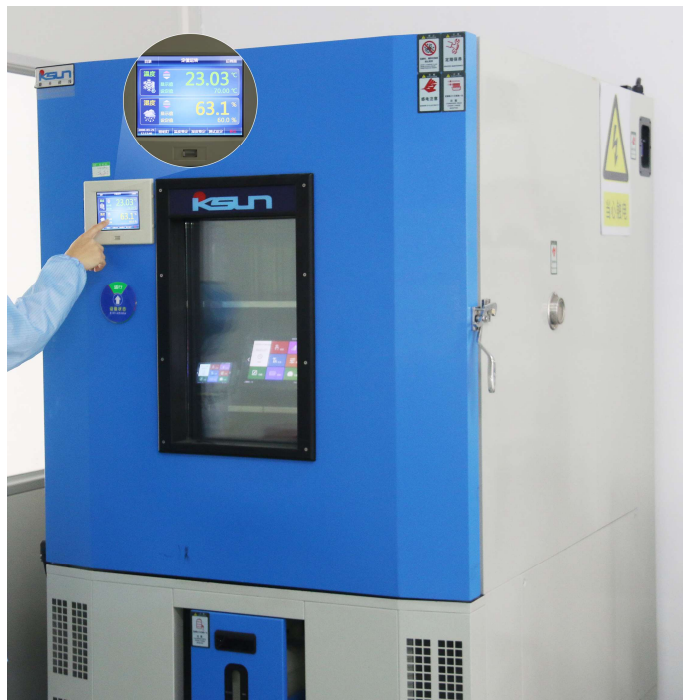
图 5-7 高低温老化测试图
